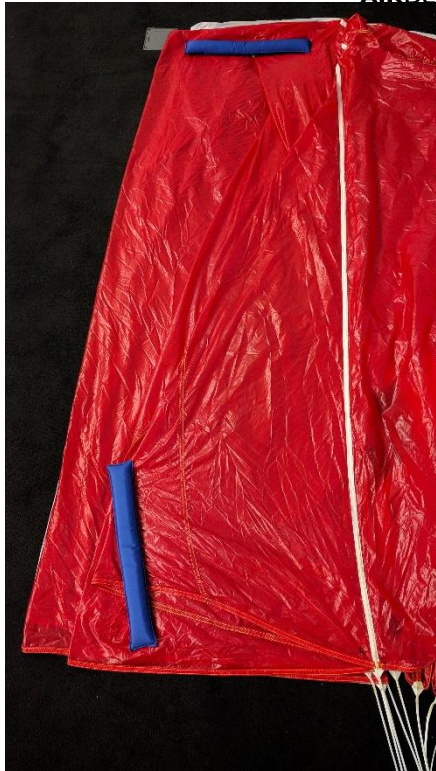
7. Bei den nächsten Bahnen wieder die Bahnen so weit zur Seite herausziehen, dass die Bahnen in etwa ein Rechteck bilden. Wiederholen Sie das mit den weiteren Bahnen bis Sie wieder auf die nächste Bahn mit Schlitz (Bahn Nr. 9) treffen.
