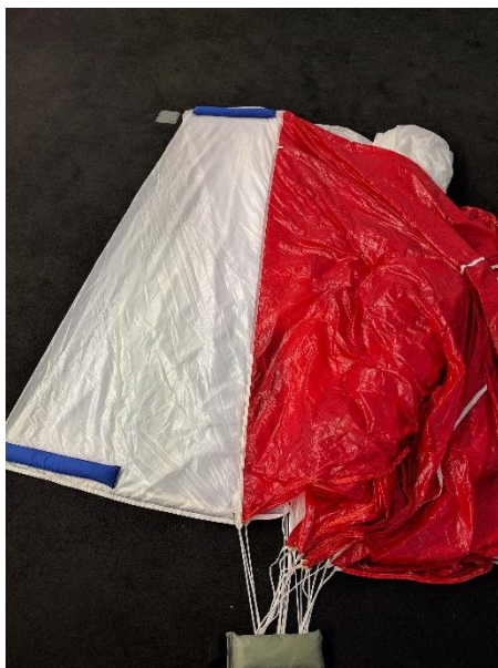
5. Arranger les autres panneaux, toujours tirer le panneau supérieur aussi loin qu'il forme un rectangle. Répéter avec chaque panneau jusqu'à atteindre le prochain panneau incluant un événement.
