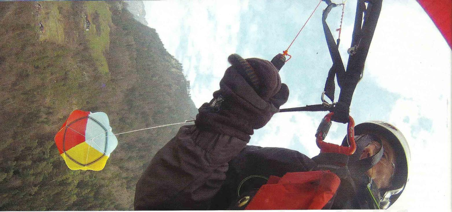
Spiral Buddy mit D-Gurt-Verbindung: Gut erkennbar die heruntergezogenen D-Gurte. Im Vordergrund der offene Container.
